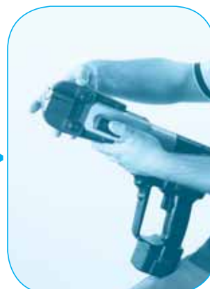
Bloquear as maxilas fechando-se o pino de retenção.
